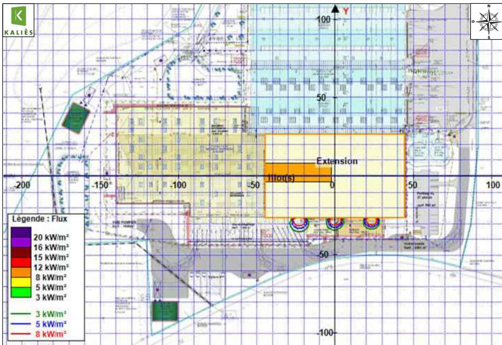
Figure 8. Flux thermiques dans le cas d'un stockage 4320 en masse en cellule 3
